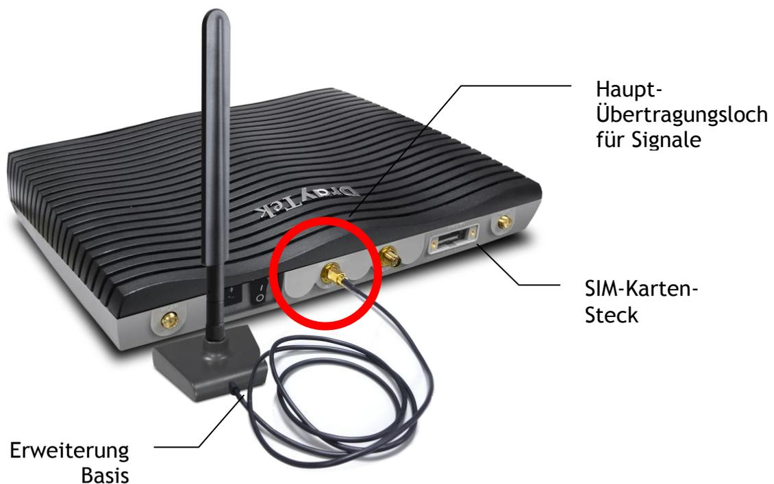
Hinweis: Wenn nur eine Antenne installiert werden soll, verwenden Sie bitte die Montagebuchse (Haupt-Signalübertragungsloch) in der Nähe des Netzschalters.
