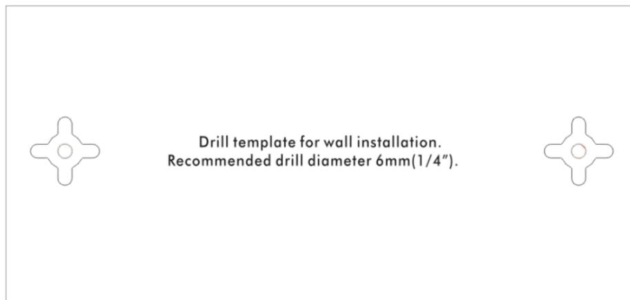
2. Platzieren Sie die Schablone an der Wand und bohren Sie die Löcher gemäß der empfohlenen Anleitung.
